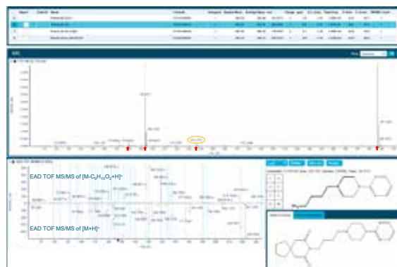
图 1. 丁螺环酮一级质谱图个准分子离子峰信息。丁螺环酮对应的4个母离子（红色箭头所示）产生的EAD二级质谱图。源内裂解碎片 [M-C_9H_{10}O_2+H]^+ 产生的MS/MS 中发现了新的碎片，例如m/z 127.12，可以辅助相应的开环代谢物的归属。
