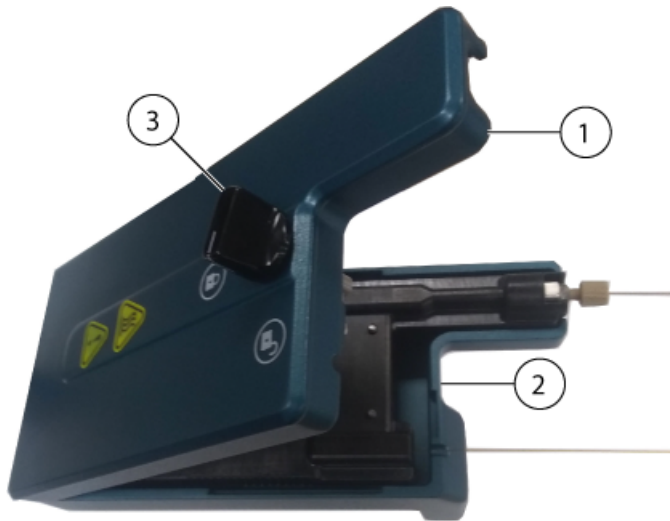
Figura 3-16 Parte trasera y delantera del calentador de columna Nano
