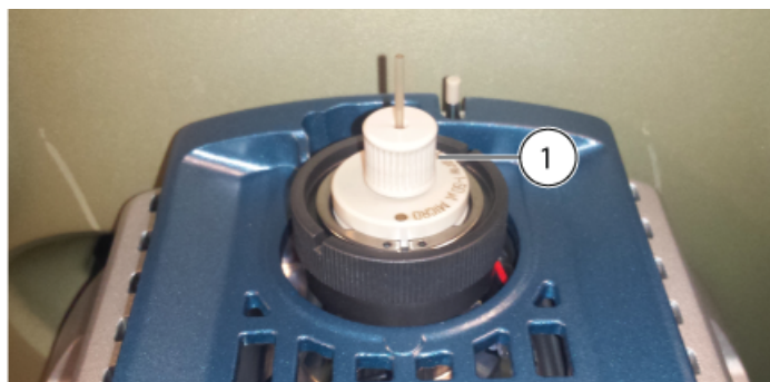
Figura 3-3 Conector inferior instalado
